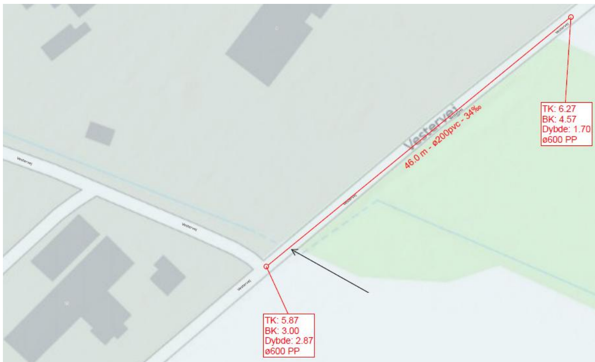
Figur 1: Spildevandsledningen er tegnet med rød. Krydsningen af vandløbet sker ved pilen.
