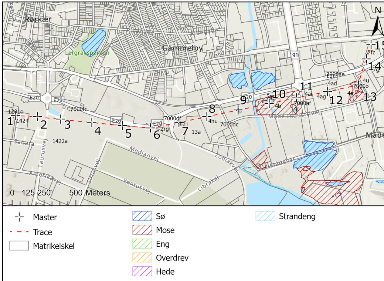
Figur 2. Oversigtskort med placering af højspændingsmaster, der ønskes revet ned samt forekomst af beskyttet natur. Masternes nummerering er angivet samt matrikelnummerering for de matrikler, tracéet krydser. Målestoksforhold 1:18.000.
